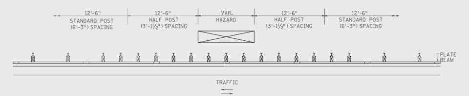
GUARDRAIL STIFFENING - HALF POST SPACING
