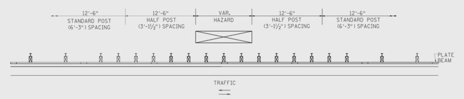
GUARDRAIL STIFFENING - HALF POST SPACING
