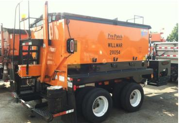
FIGURE 9: HEATED BITUMINOUS HOPPER
