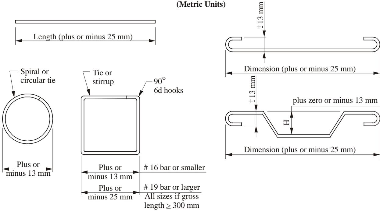
**STANDARD FABRICATION - CUTTING & BENDING TOLERANCES**
